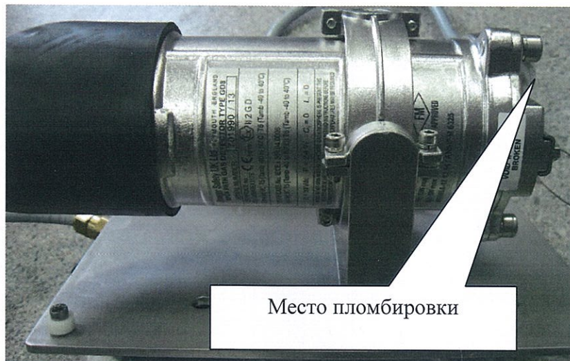
Рисунок 2 – Место пломбирования корпуса газоанализатора от несанкционированного доступа на примере блока передатчика (блок приемника пломбируется аналогично, на рисунке не показан)
