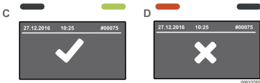
**C)** Není zjištěn žádný alkohol. Zkouška je negativní. Kromě toho se rozsvítí zelená kontrolka. Po 2 sekundách bude přístroj opět připraven k použití.
