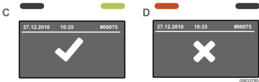
**C)** Alkohol nije otkriven. Test je položen. Pored toga, svijetli zelena LED lampica. Nakon 2 sekunde instrument će ponovo biti spreman za korištenje.
