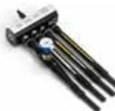
Адаптер с импактором подключен к Dräger AeroTest Simultan
