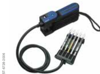
Совместный тест-комплект I для одновременного измерения неорганических пожарных газов.
