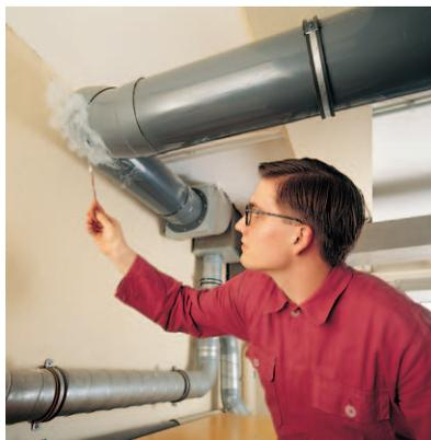
Рис. 35: Тестер воздушных потоков ф. Dräger
