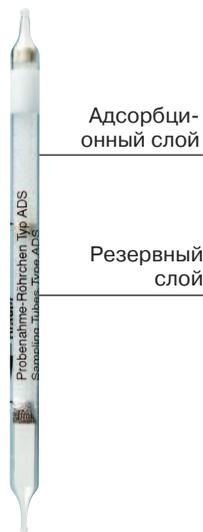
Рис. 41: Пробоотборная трубка ф. Dräger
