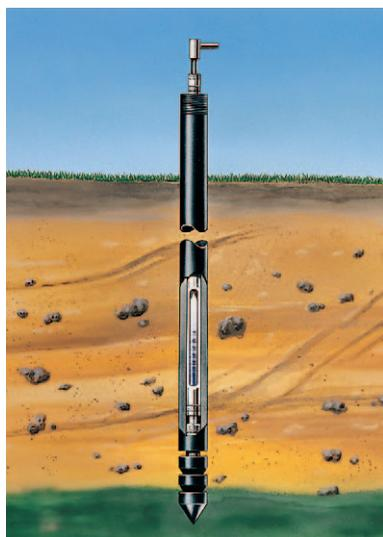
Рис. 34: Профессиональный зонд фирмы Dräger в разрезе
