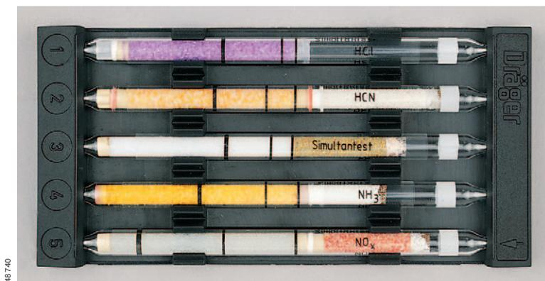
Рис. 20: Совместный тест-комплект I для одновременного измерения неорганических пожарных газов.
