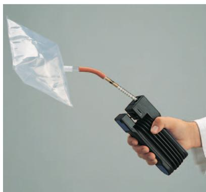
Рис. 23: Измерение CO в выдыхаемом воздухе
