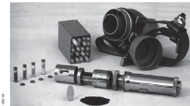
Рис. 5: Насос для газоизмерительных трубок, 1950 г.
